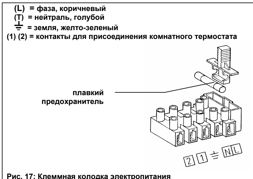
Рис. 17: Клеммная колодка электропитания
